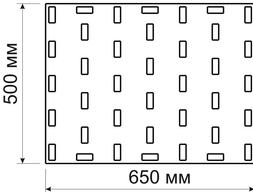
Перед установкой скотча двустороннего следует отчистить приклеиваемые поверхности от пыли и грязи, а также обезжирить (с помощью спирта, растворителя, ацетона и прочих жидкостей).
