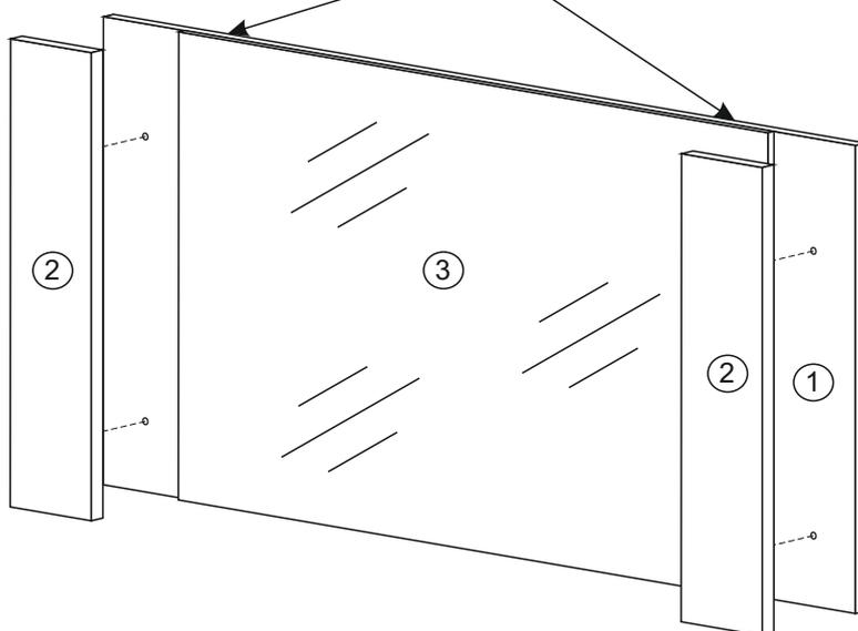
1. Сборка производится горизонтально. На задник 1 с уже приклеенным на него зеркалом 3 установить навесы и прикрепить планки МДФ при помощи шурупов 3,5\*25 мм. Готовое зеркало навесить на стену при помощи ранее установленных навесов и дебелей с шурупом.
