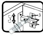
Если необходимо отрегулировать створку по высоте, нужно ослабить винт 3, отрегулировать створку в направлении С-С, а затем затянуть винт 3.
