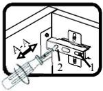
Если створка наклонена влево или вправо относительно вертикали корпуса, нужно выправить наклон створки в направлении А-А винтом 2.
